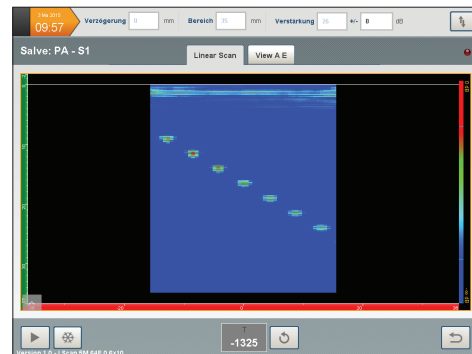
线扫图 相控阵探头范围内依次激发探头阵元
