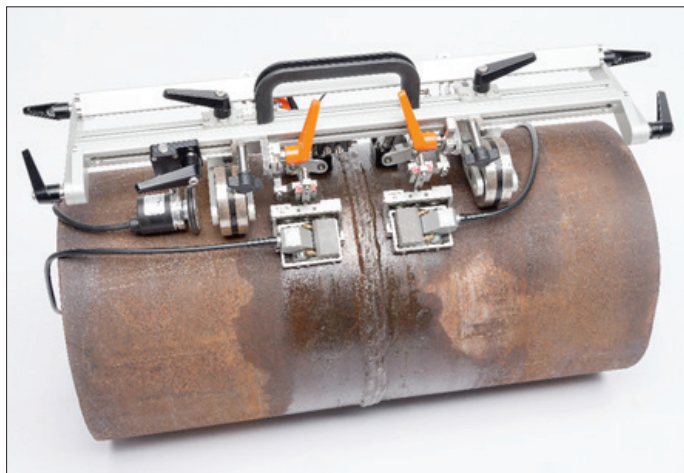
钢管对接焊缝及环焊缝的手动扫查器，带编码器，磁化吸盘，探头架带两个相控阵探头和TOFD
