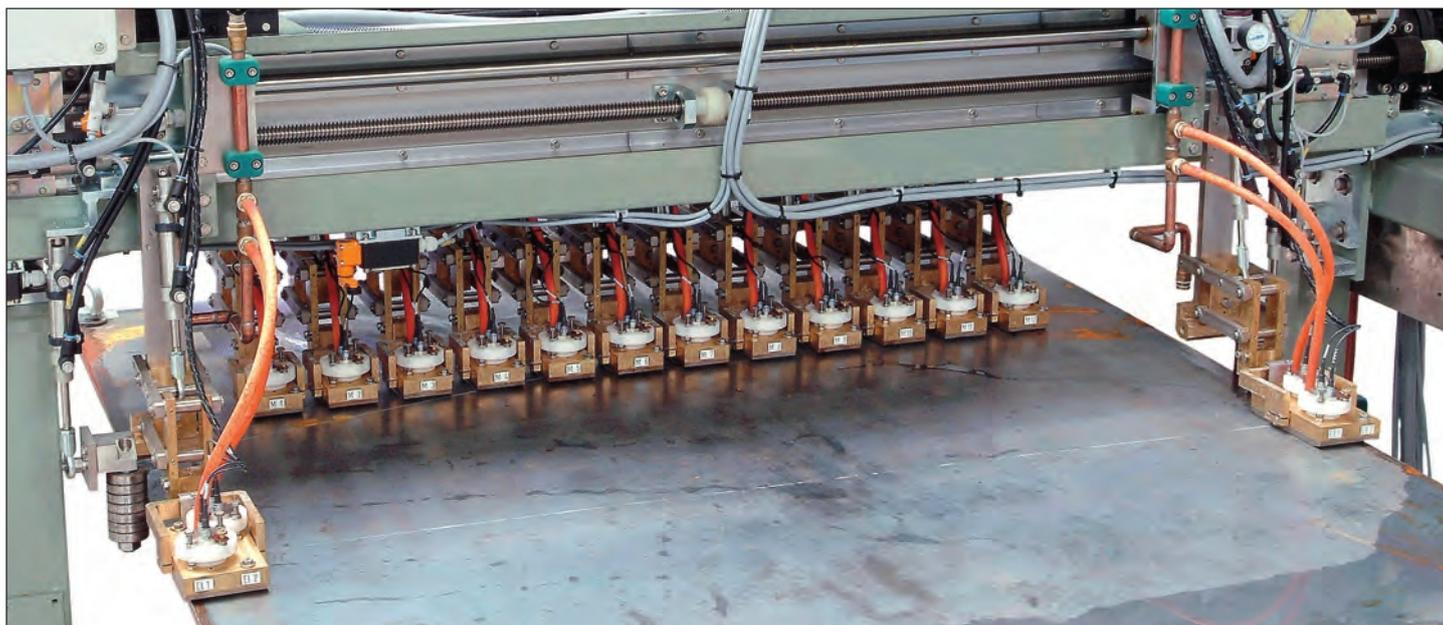
带钢或板材被送入检测系统中心的检测区域内。带钢上方的探头系统为自动化控制。检测探头架通过气动控制系统下降到检测位置，系统自动检测带钢边缘及带钢中心区域的缺陷。检测结束后，探头系统自动抬起并返回到安全的位置。
