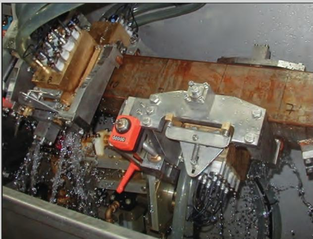
用于检测方坯的四个探头架，每个探头架上带有7个探头，固定于工件四周。通过导向辊和滚轴滑动实现导向。
