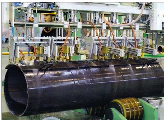
用一段焊接管件对检测系统的探头架进行校准 (图片来自EEW-Korea)
