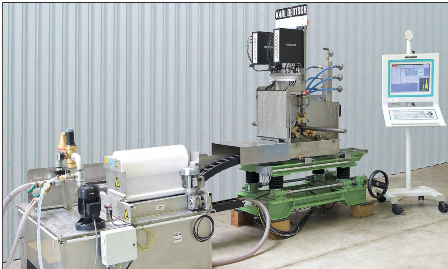
配有水处理系统、检测台架和操作面板的棒材检测系统
