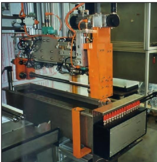
用八个探头检测转向齿条的小型检测箱
