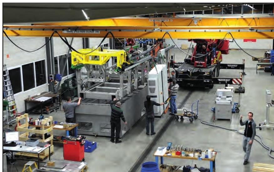
组装车间里正在组装一个大型水浸检测箱
