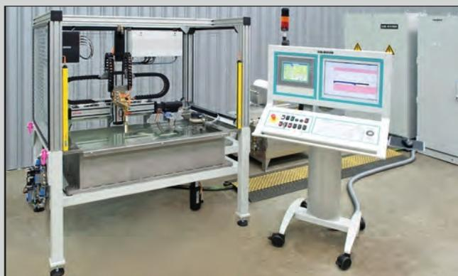
图例：配有水浸箱、探头架和水过滤循环系统的ECHOGRAPH检测电子设备：操作面板为触摸屏，可用来进行PLC参数设置；还有一个工业键盘，可用来对超声波检测参数进行设置。
