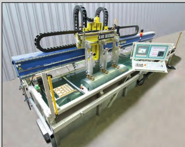
图例：检测铝合金旋转体工件的测试箱
