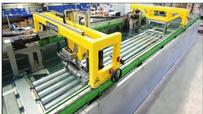
图例：用于检测棒件、型材和管件的大型水浸检测箱。一次可同时检测多达6件工件。
